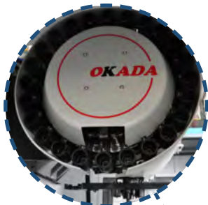
Автоматическая смена инструмента (24 позиции)
