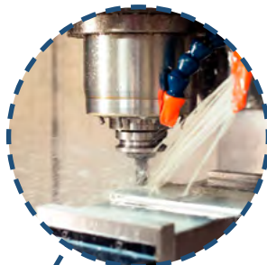
Система подачи СОЖ через шпиндель (30 бар)
